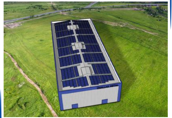
3D yerleşim planı çıkartılarak gölge analizi yapılır.
