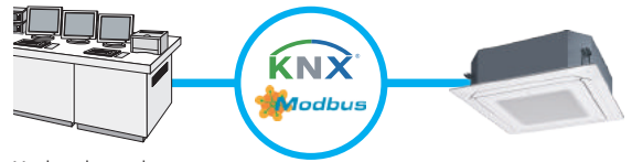
Merkezi kontrol sistemi
