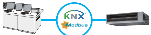
Merkezi kontrol sistemi
