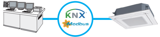
Merkezi kontrol sistemi
