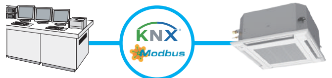
Merkezi kontrol sistemi
