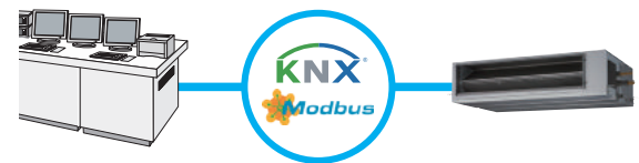
Merkezi kontrol sistemi
